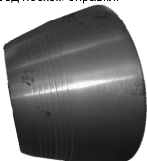
Рисунок 2 - Валок прошивного стана с опытной калибровкой
