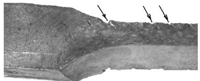
Рисунок 1 - Недокат зразка реологічно складного Pb-сплаву. Стрілками позначені кутові рванини
