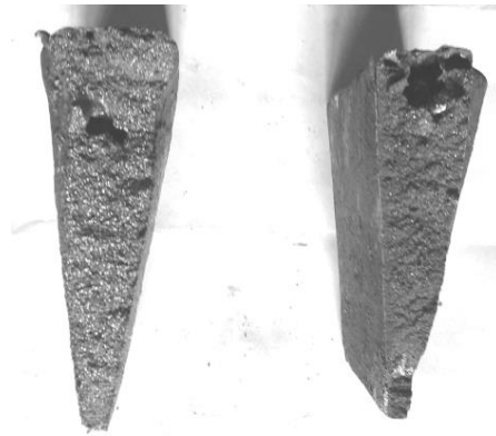
Рисунок 3 – Злам немодифікованого (зліва) та модифікованого чавунів
