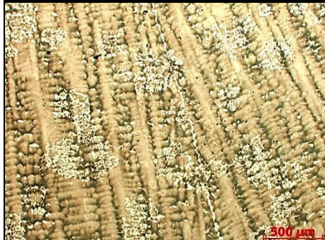
Рисунок 1 - Мікроструктура металу по перерізу БЛЗ 335x400мм
