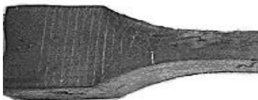
Рисунок 4 - Недокат зразка зі сплаву свинцю С1 з 3% Sb після обтиснення \varepsilon \approx 60\% з обмеженням розширення штаби. Дефекти відсутні
