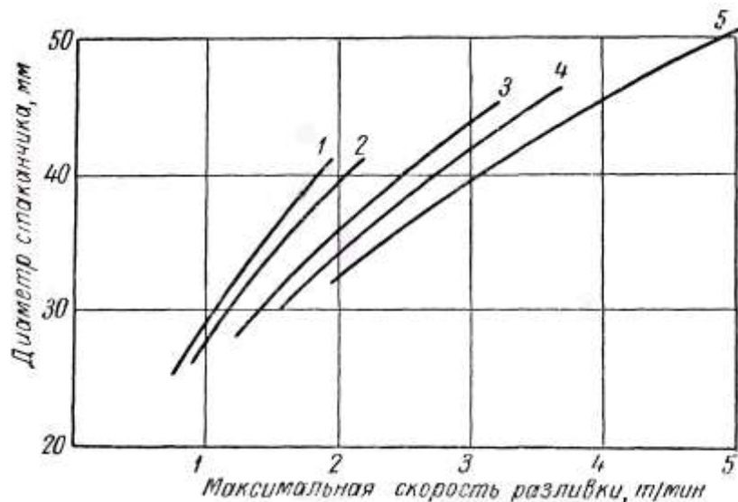
Ф. 20. Диаграмма для выбора диаметра отверстия в стопорном стаканчике для разливки стали.
